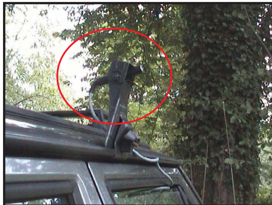
Photo n° 37 : Micro ultrason fixé sur le véhicule. Crédit photo P. Lustrat
